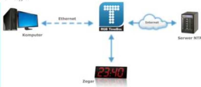
Rys. 1. Bezpośredni tryb pracy Internetowego Systemu Synchronizacji Czasu
